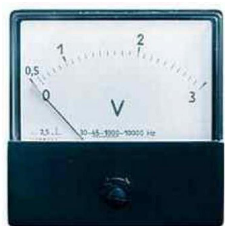
Вольтметр – электрический прибор для измерения ЭДС или напряжений в электрических цепях. Вольтметр включается параллельно нагрузке или источнику электрической энергии.
