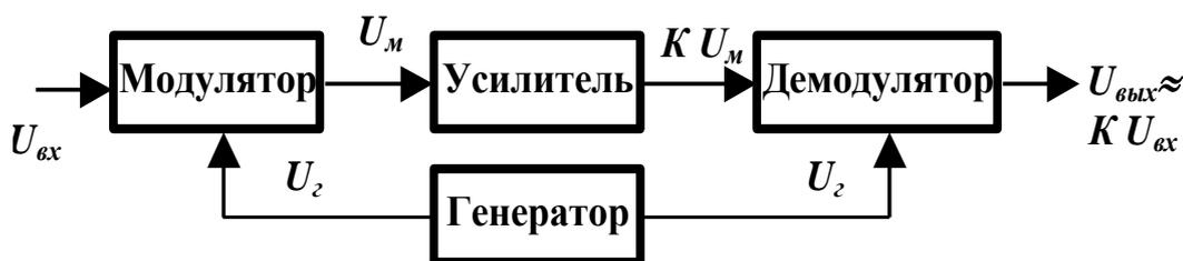
Рисунок 1.13. Структурная схема УПТ с преобразованием
